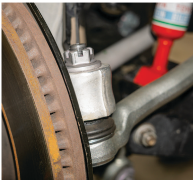
Fig. 1: Tie rod end link.
