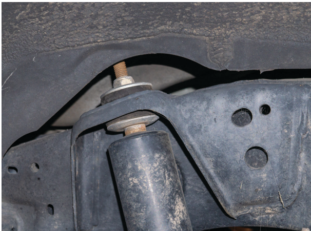
Fig. 20: Remove stem top nut.
